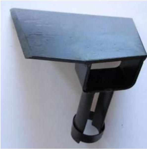
Мотыга выполнена в виде заострённого клина с двумя режущими кромками. При этом пластина мотыги имеет рассчитанный центр тяжести. Это позволяет работать любой заострённой кромкой. Благодаря своей форме и весу мотыгой значительно легче рыхлить тяжёлые и плотные почвы. Клин осуществляет лёгкое вхождение в почву и рыхлит её верхний слой.
